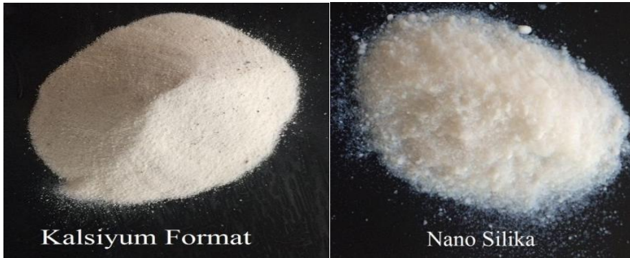
Şekil 2. Çalışmada kullanılan nano silika ve kalsiyum format Figure 2. Nano silica and calcium formate used in the study
