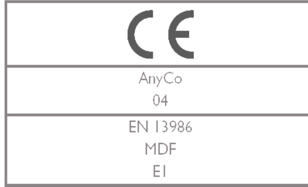
Şekil 2. Kuru şartlarda iç kullanım için standart MDF'nin CE işaretlenmesinin özet olarak gösterimi
