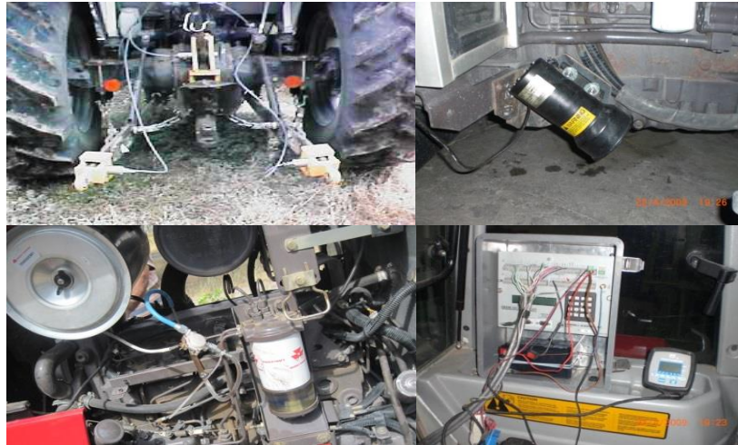
Şekil 3. Güç ölçüm sistemi ve depolama ünitesi
