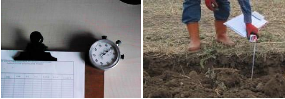
Şekil 4. Zaman etüt tablası ve iş derinliği ölçümü
