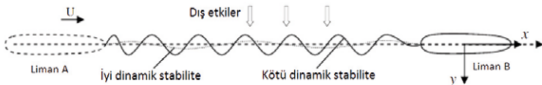
Şekil 7. Düz rotada dış etkilere maruz kalan bir geminin izlediği farklı rotalar (Zaojian, 2006).
