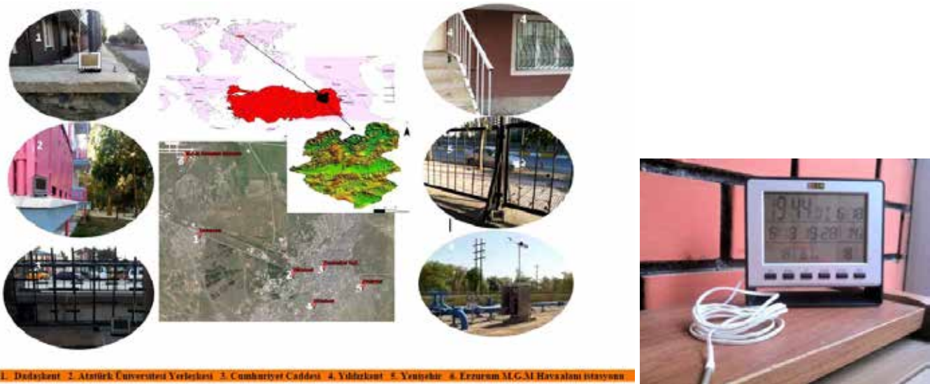
Şekil 1. Çalışma alanının lokasyon haritası ve ölçüm aleti (Araştırmada kullanılan YCOM – KMN 305 iç/dış ısı ve nem ölçer ve kaydeden cihaz
