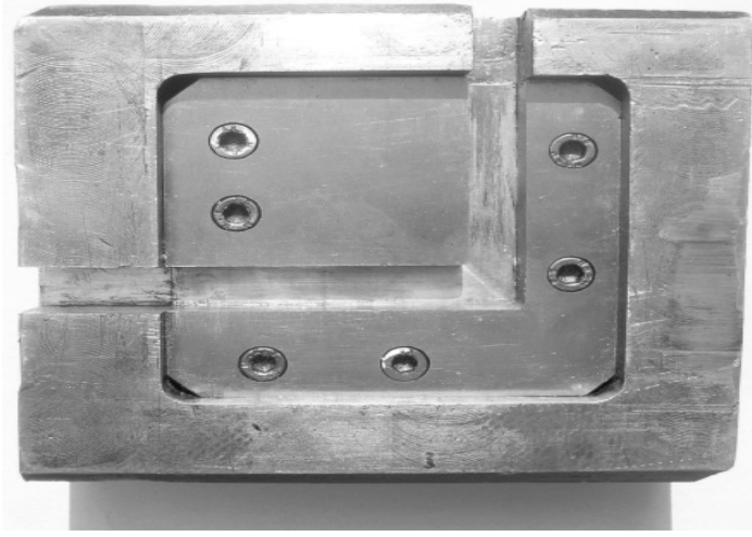
Şekil 2. EKAP kalıp örneği [8].
