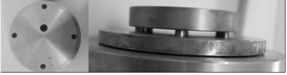
Şekil 6. Üst kapak ve çıkarma pimleri
