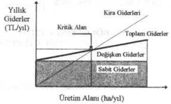
Şekil 1. Tarım Makinalarında Yıllık İşletme Giderlerinin, Üretim Alanına Göre Değişimi (Mutaf ve Uçucu, 1980; Işık ve ark., 1988; Sayın ve Özgüven, 1995)
