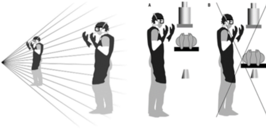
Şekil 2a. X-ray kaynağından uzaklığın artırılması ile radyasyon maruziyetinin azalması (uzaklığın iki misline çıkarılması alınan doz miktarını 4 kata kadar azaltabilir) 23 .
