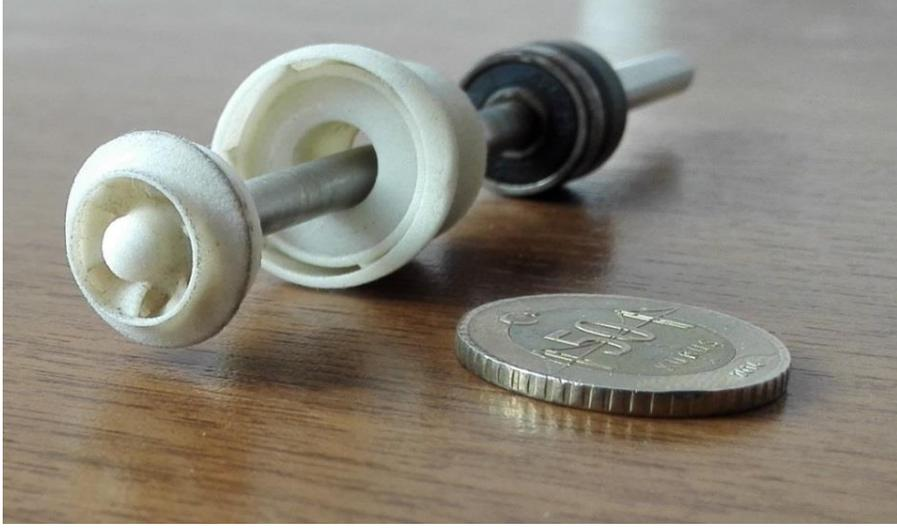
Şekil 10. Lazer sinterleme teknolojisi ile üretilen çark ve difüzörün fotoğrafı
