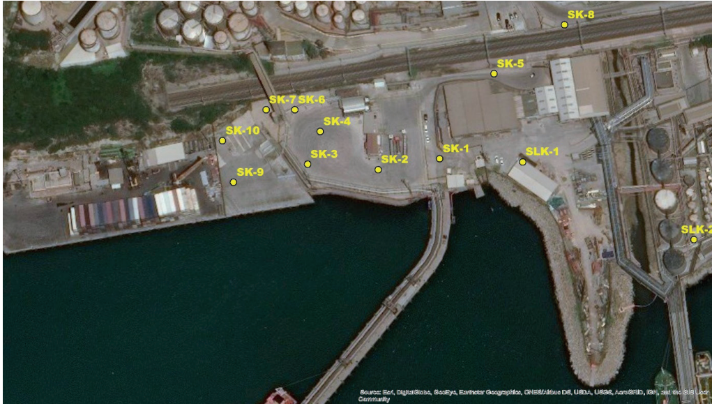
Şekil 5: Narca Dere ağzı ve yakın çevresi güncel yapay kıyı ve yakın çevresinde yapılan sondajların lokasyonları (SK1-SK10). Figure 5: The current artificial coast, the locations of the drillings (SK1-SK10) performed in the Narca Creek mouth and its close vicinity.
