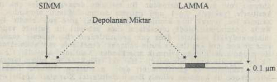
Şekil 5. Çok ince bir kesitte SIMS ve LAMMA analizinden sonra örnekte meydana gelen aşınımların derinlikleri.
