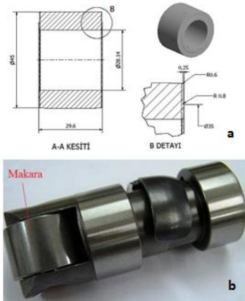
Şekil 1. a) Kam makarasının boyutları (Cam roller dimensions), b) Kam makarası itici gövdesine montajlı hali (Mounting of the cam pulley on the propulsive body)
