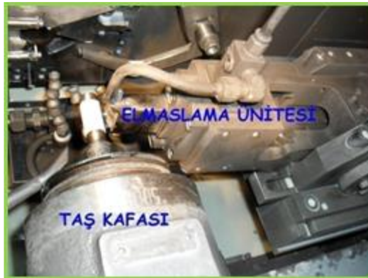
Şekil 4. Taş kafası, elmaslama ünitesi ve parçanın bağlanmış görüntüsü (Stone head, diamond unit and attached image of the piece)
