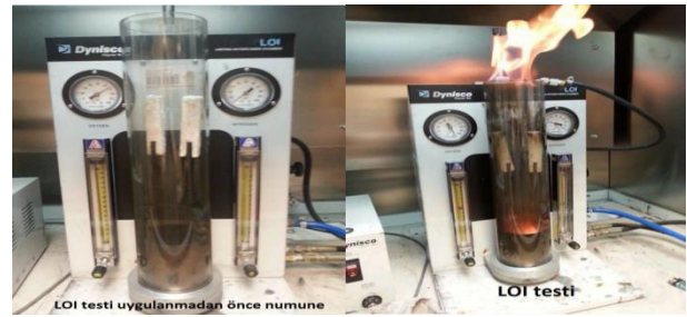
Şekil 1. LOİ Test Düzeneği (Dynisco LOI apparatus)
