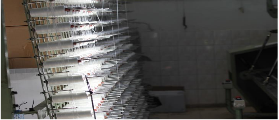
Şekil 1. Ege Balık Ağları'nda Dyneema lifinin bobinlere sarılarak ip haline getirilişi
