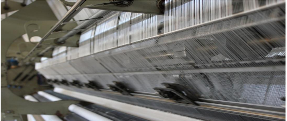
Şekil 2.Ege Balık Ağları Fabrikasında Dynema'nın dokunma anı
