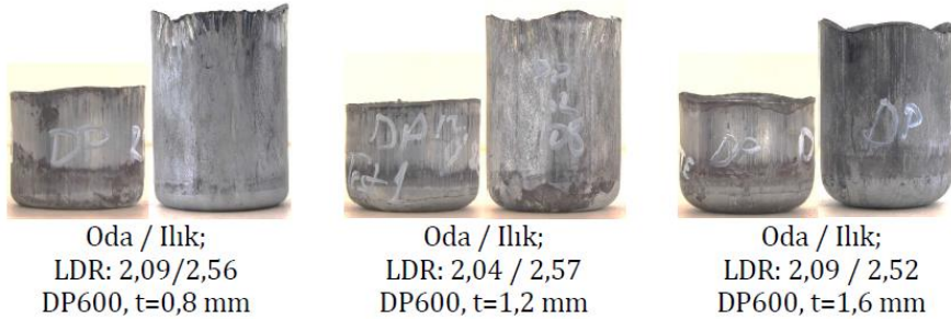
Şekil 11. Oda ve ılık sıcaklıklarda derin çekilen numuneler
