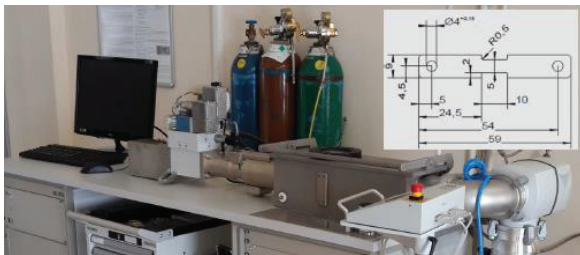
Şekil 7. Baehr deformasyon dilatometresi ve test numunesi
