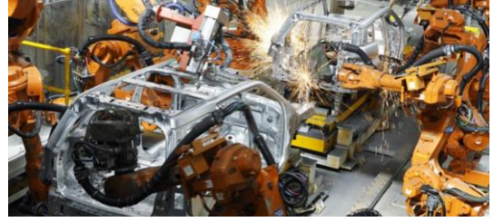
Şekil 2. Otomobil gövde üretim hattı [7]
