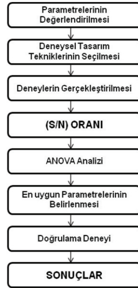
Şekil 7. Taguchi yönteminin akış diyagramı
