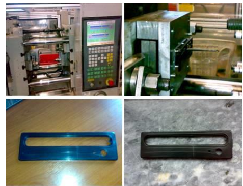
Şekil 2. Plastik numunelerin enjeksiyon işlemleri
