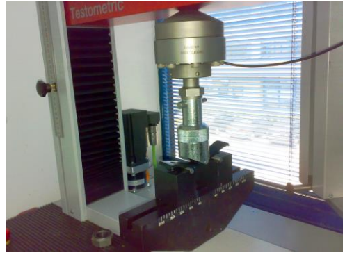
Şekil 4. Üç noktalı eğme testi
