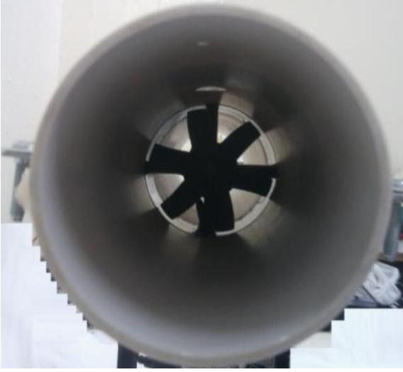
Şekil 5. Boru İçindeki Kanal Fanı Sistemi
