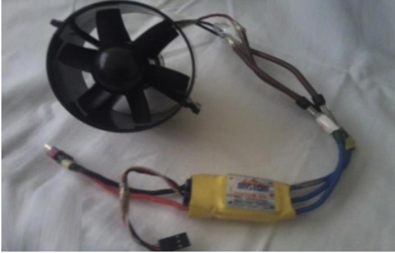
Şekil 1: Kanal Fanı Sistemi
