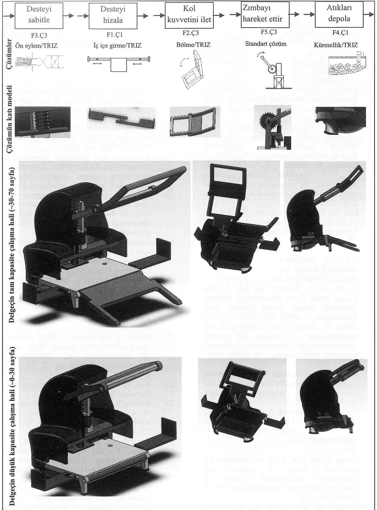
Şekil 7. Örnek bir delgeç tasarım birleşimine ait katı modeller
