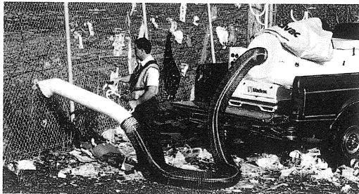
Şekil 19. Farklı Modelde Vakum Kolu [4]
