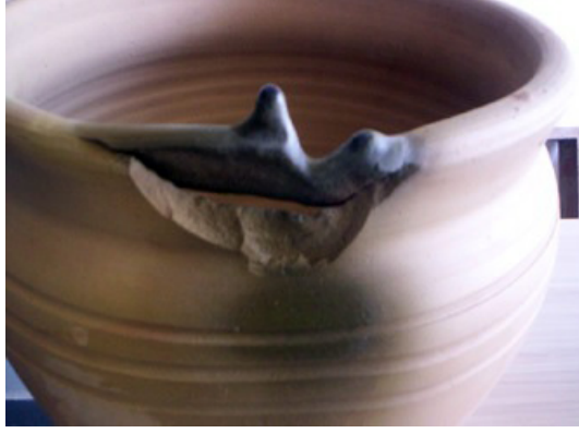
Görsel 9. Fırınlama işleminde ateş vurması örneği (Günümüz uygulaması)
