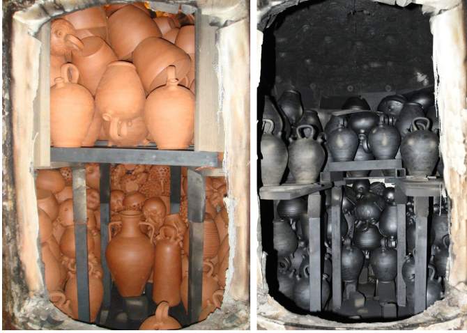
Görsel 13. Atölye Roca Caus, siyah pişirim öncesi ve sonrası fırın, Verdu
