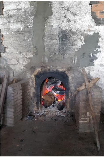
Görsel 17. Fırının odunla alt bölgeden ateşlenmesi
