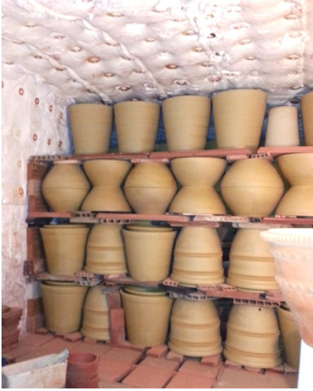
Görsel 14. Atölye Bonadona'da fırında dizilmiş ürünler
