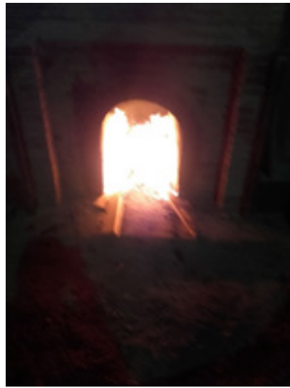
Görsel 17. Fırının odunla alt bölgeden ateşlenmesi
