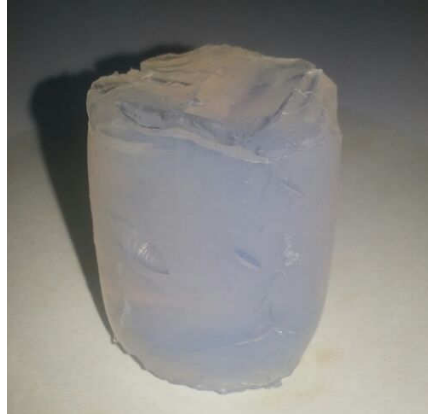
Şekil 5. Metanol banyo süresi tamamlanan alümina arojel.
