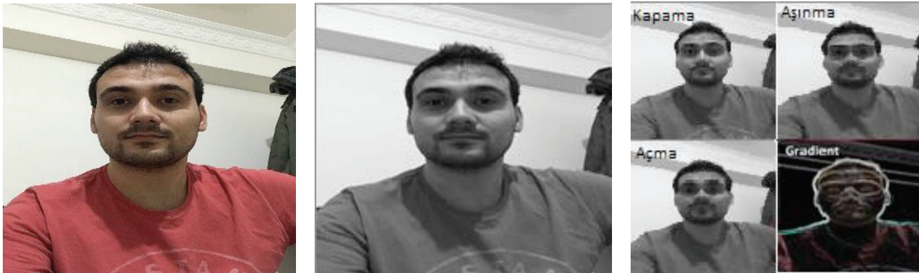
Şekil 2. a) Orjinal resim b) Gri renk uzayında resim c) Morfolojik işlemler sonucu resim çıktıları
