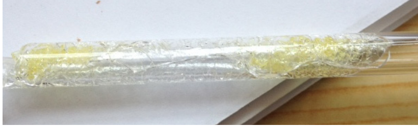
Şekil 5. Deney sonrası oluşan Pb eriyiği
