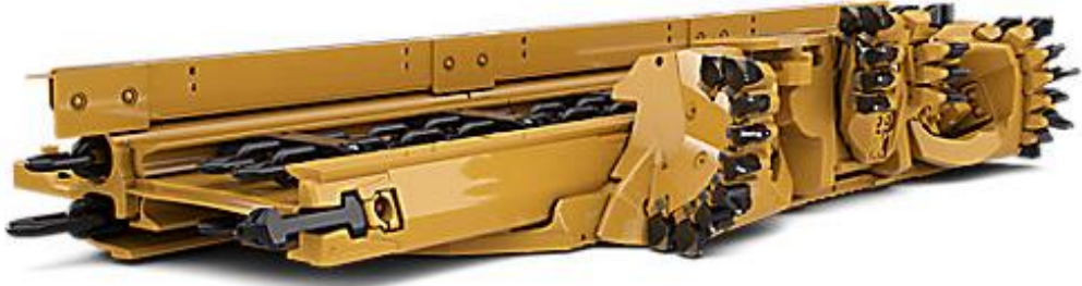
Şekil 5a. Koparıcı saban (Cat.com., 2017), Figure 5a. Base Plate Plow (Cat.com., 2017),
