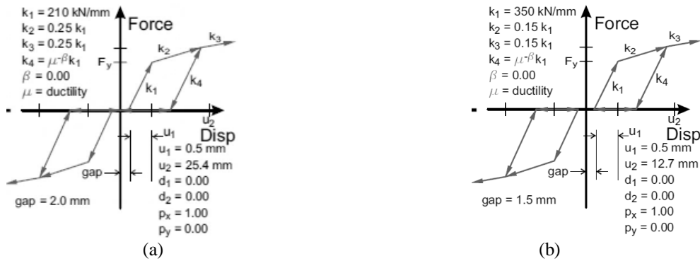
Şekil 3. a) Boyuna doğrultu için kuvvet-yer değiştirme ilişkisi b) Yatay doğrultu için kuvvet-yer değiştirme ilişkisi (Nielson, 2005)
