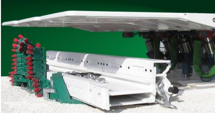
Şekil 4. Koparıcı saban (Ostroj.cz., 2017), Figure 4. Base Plate Plow (Ostroj.cz., 2017)
