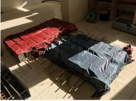
Şekil 5. Mafsallı kiriş deney numunelerine kür uygulaması.
