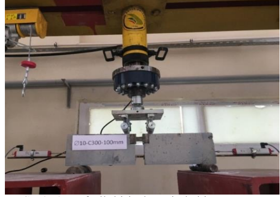
Şekil 6. Mafsallı kiriş deneyinde bir görünüm
