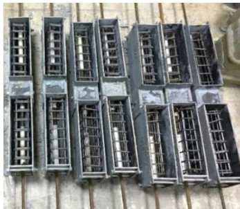
Şekil 2. Mafsallı kirişlerin üretiminde kullanılan modüler çelik kalıplar.
