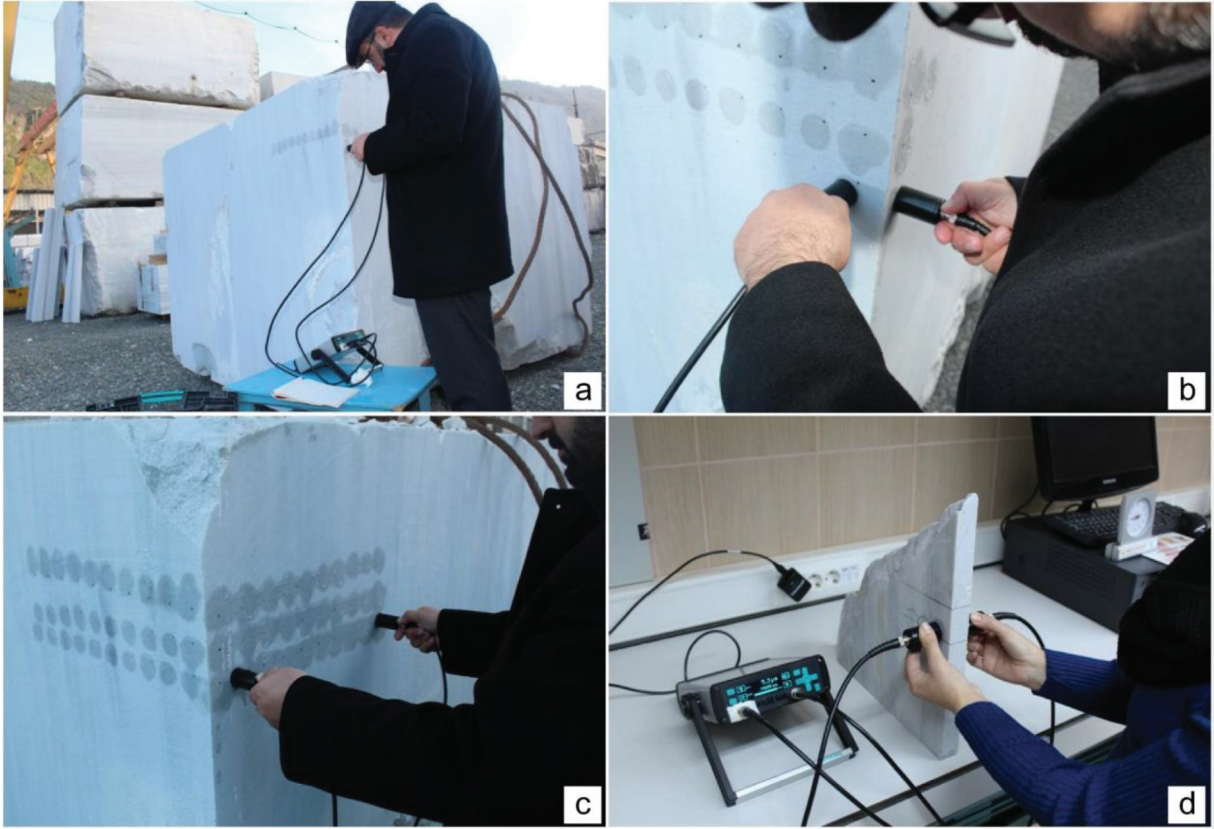
Şekil 5. Ölçüm yapılan blok (a), yarı-direkt (b), indirekt (c) ve direkt (d) ölçüm tekniğiyle ölçüm. Figure 5. Measured block (a), semi-direct (b), indirect (c) and direct (d) measurement technique.
