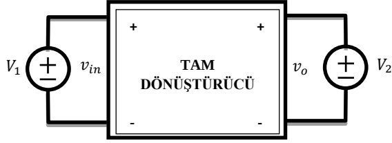
Şekil1. Tam güç işleyen dönüştürücü yapısı
