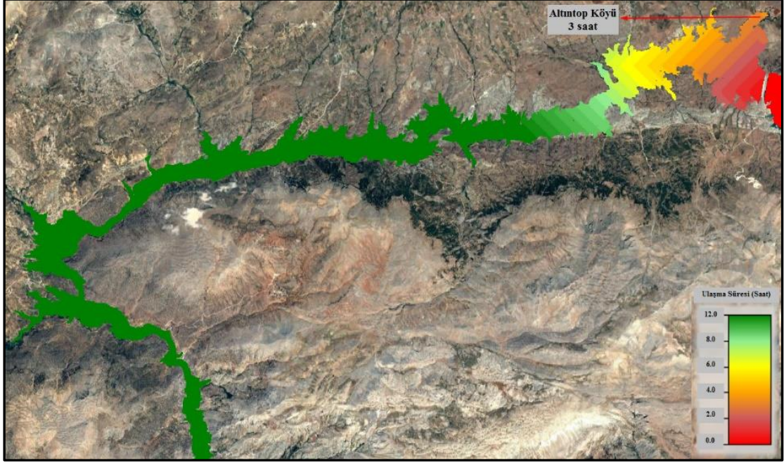
Şekil 6. Sürgü barajının yıkılması durumunda taşkın dalgasının ilerleme süreleri
