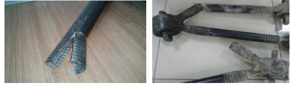
Resim 2. V-Kolu Kırılma Örnekleri
