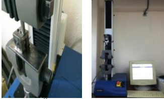
Şekil 7. Örneklerin bağlanma dayanımlarının universal test cihazında ölçülmesi
