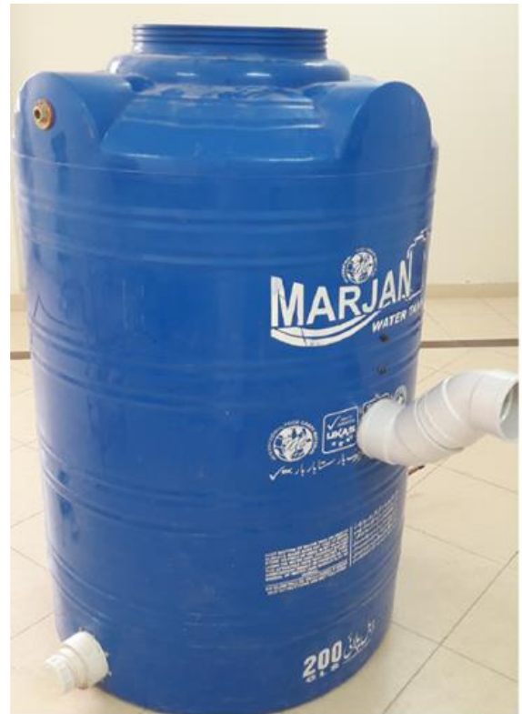
Fig. 1. A 750L biogas digester
