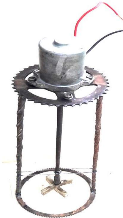
Fig. 3. A DC motor stirrers
