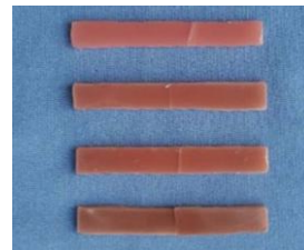
Resim1. Gruplara göre 3 nokta eğme testi ile kırılmış olan örnekler
