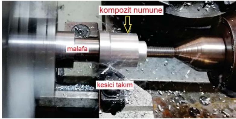
Şekil 4. İşleme deneyi ve kullanılan torna tezgahı
