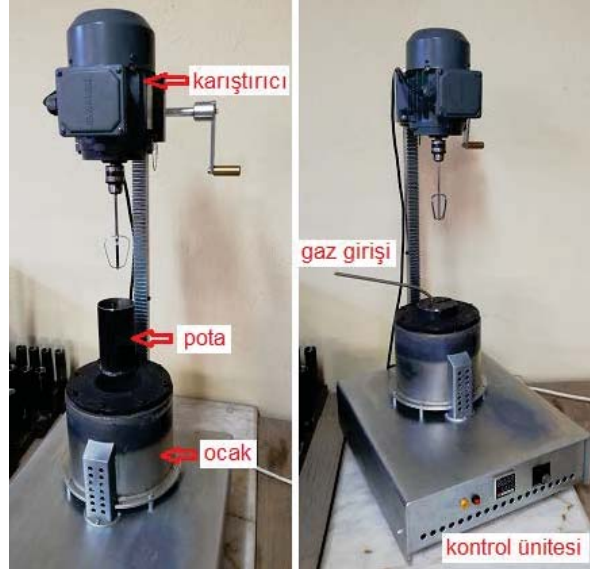
Şekil 2. Karıştırılmalı döküm aparatı
