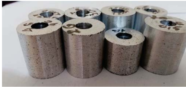
Şekil 3. Sekiz farklı takviye oranında üretilen kompozit numuneler
