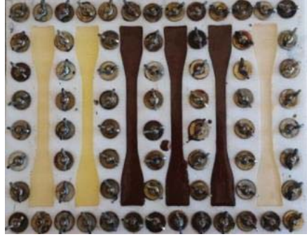
Şekil 3. ASTM D 638 standardına göre kalıplanmış kompozit numuneler.
