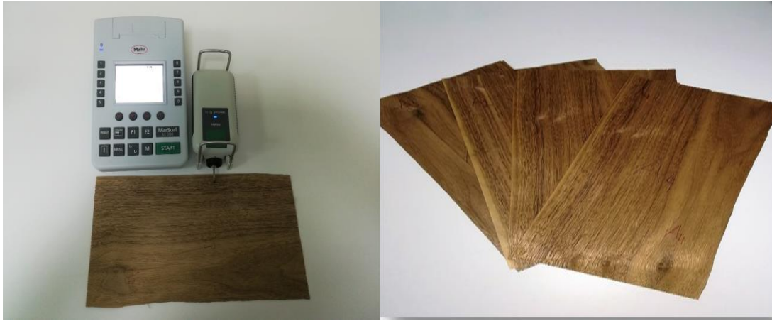
Şekil 1. Marsurf M300 ve Kayın Kaplama Test Numuneleri
