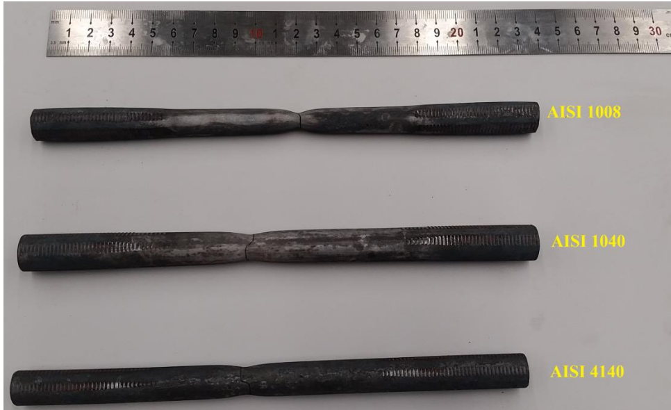
Şekil 3: Isıl işlem sonrası çekme testi numuneleri
