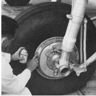
Şekil 4. Uçakların iniş takımlarına penetrant sıvı testinin uygulanması (Shull, 2002).
