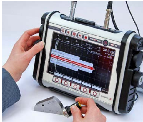
Şekil 7. Ultrasonik muayene yönteminin güncel uygulamalarından bir örneği (Konya NDT, 2018).
