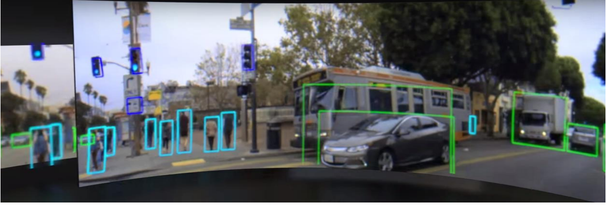
Şekil 2. Otonom araçta nesnelerin tanımlanması (NVIDIA DRIVE Autonomous Vehicle Platform)
