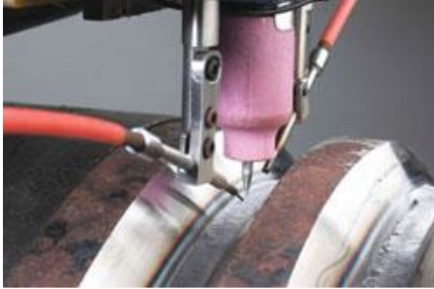
Şekil 2. Orbital kaynak sistemi ve torç hareketleri [2, 6]
