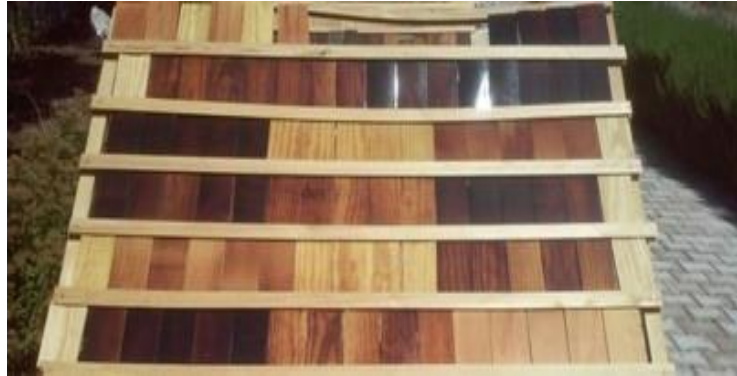
Şekil 1. Doğal yaşlandırmaya bırakılan deney örnekleri
