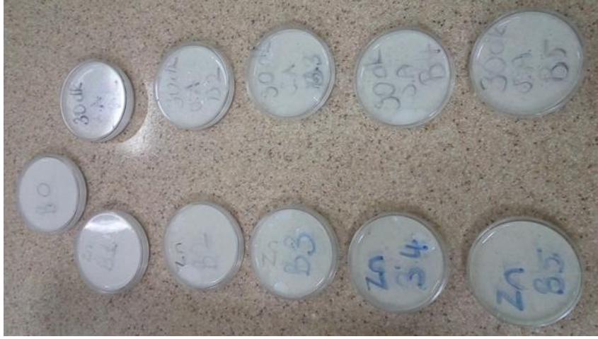
Şekil 2. Şekillendirilen polimer kompozit numuneler
