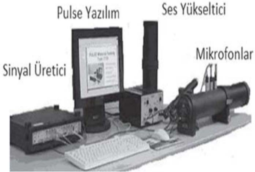
Şekil 17 Çift Mikrofon Empedans Tüp Yöntemi Ölçüm Düzeneği Tablo 1: I, II Ve III Numaralı Kumaşların Ses Yutum Katsayısı Değerlerinin Karşılaştırılması
