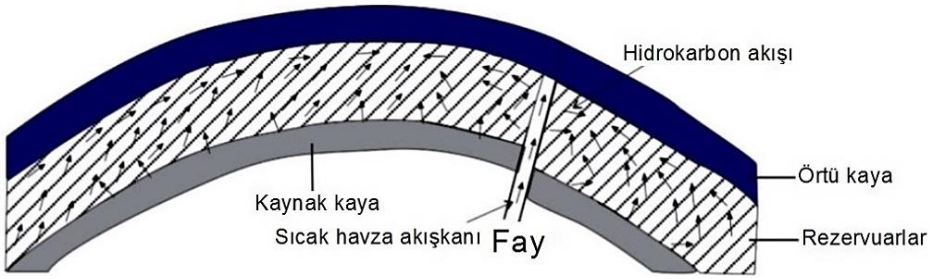
Şekil 2.2. Bir fay zonundaki akışkan göçünün şematik modeli (Jin ve ark., 2008'den)
