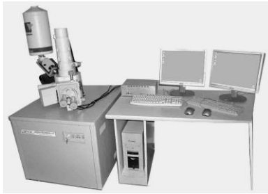
Şekil 2. Jeol JSM 6060 LV marka SEM cihazının fotoğrafı
