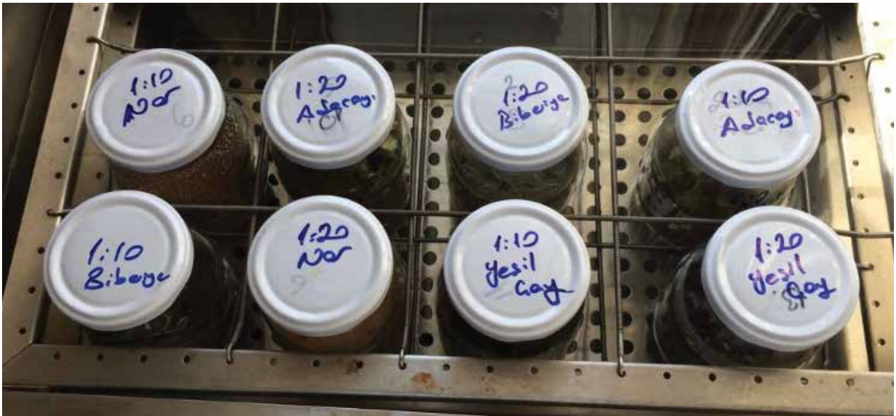
Şekil 3. Ekstraksiyon işleminin su banyosunda 90°C sıcaklıkta gerçekleştirilmesi.
