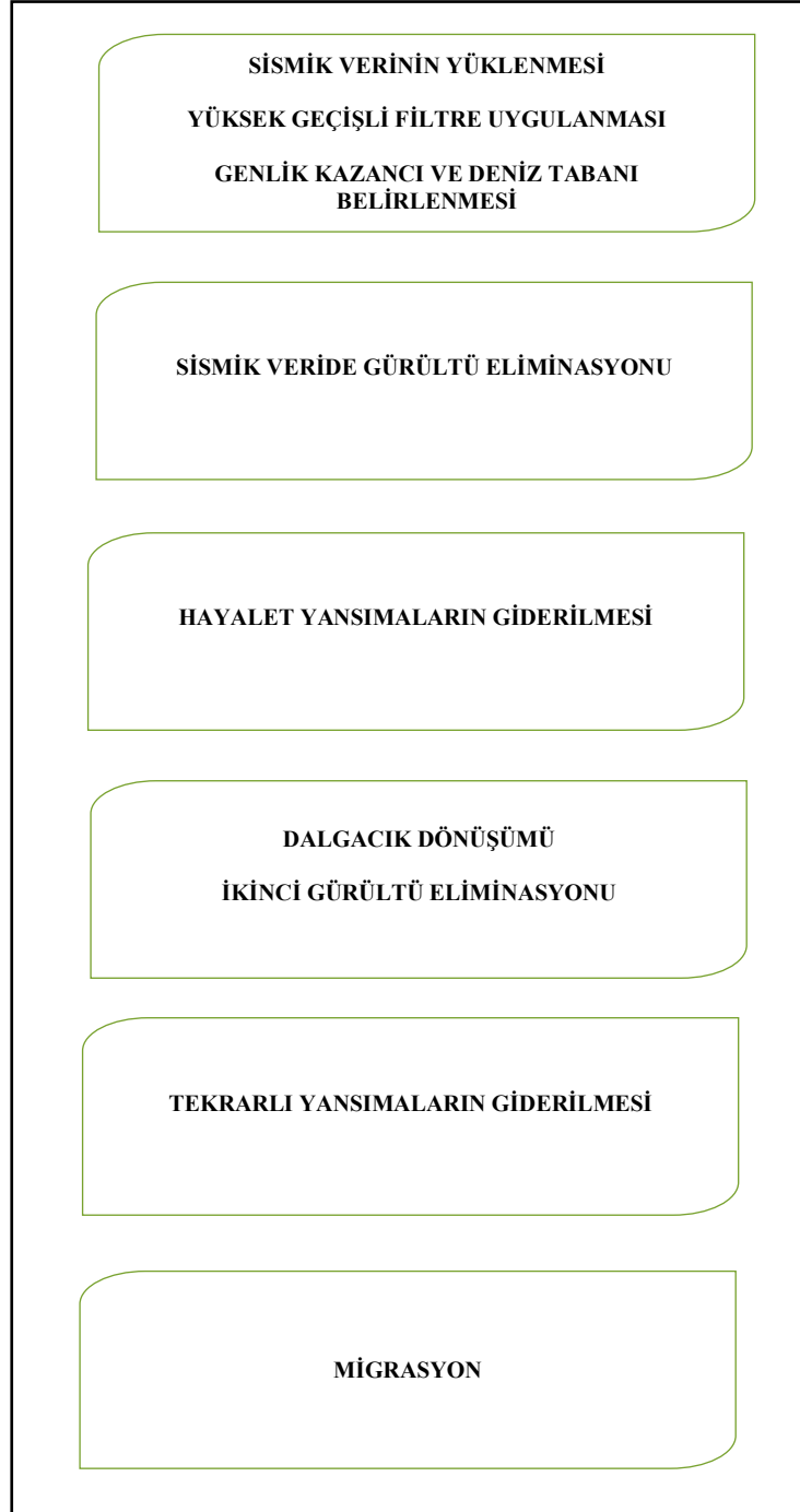
Çizelge 2. Sismik veri işlem aşamaları Table 2. Seismic data processing steps
