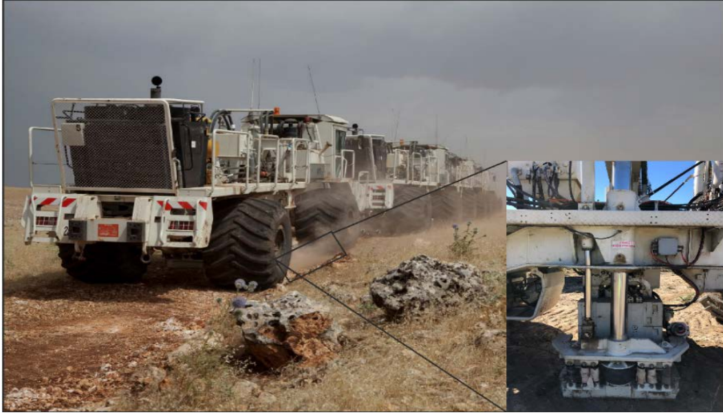
Şekil 3. Vibratör sistemi ve tablası Figure 3. Vibrator system and its table
