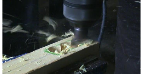
Resim 10. Dillik Yuvasının Açılması
