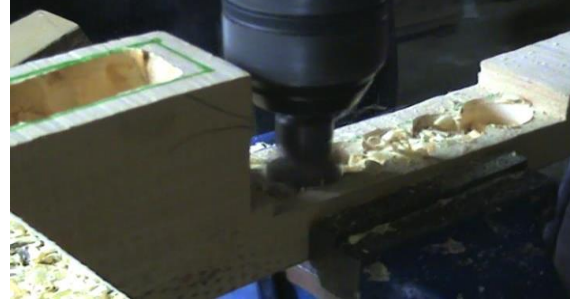
Resim 8. Matkap yardımıyla analık yatağının açılması
