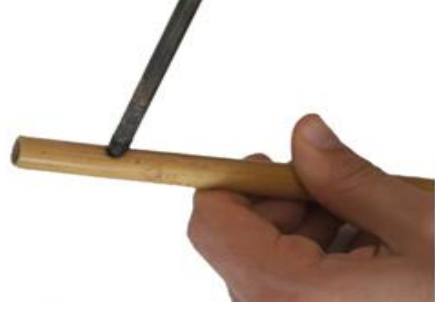
Resim 17. Analık Kamışlarının Deliklerinin Açılması
