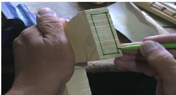
Resim 3. Nav'ın Kepçe Bölümünün Ölçülendirilmesi
