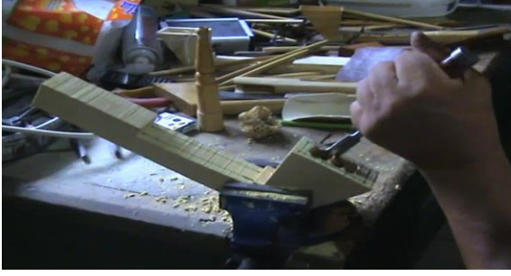
Resim 7. Iskarpela yardımıyla kepçenin iç kısmının genişletilmesi
