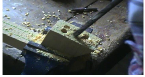
Resim 6. Kepçe Bölümünün Matkap Yardımıyla Oyulması
