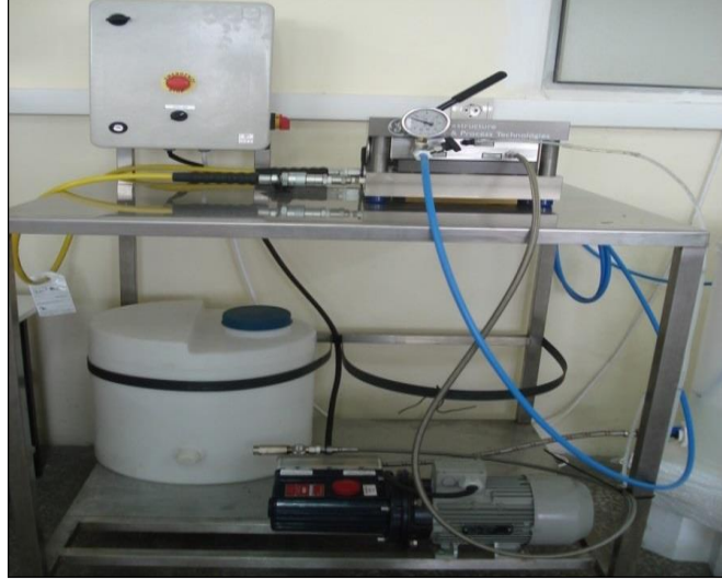
Şekil 1. Laboratuvar ölçekli çapraz akış düz tabaka membran test ünitesi.
