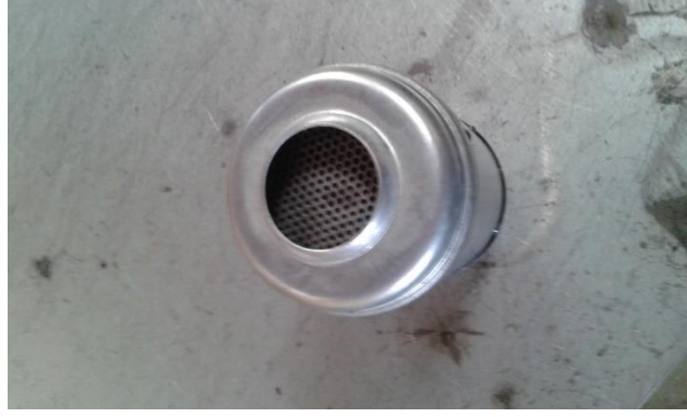
Şekil 5. Filtre uç kapağı
