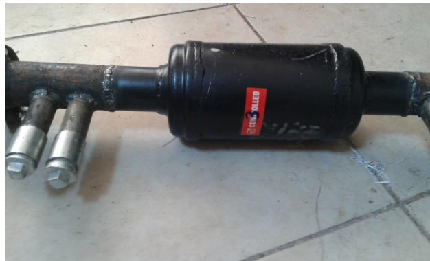
Şekil 9. Filtrenin DPF girişinde ölçüm yapma
