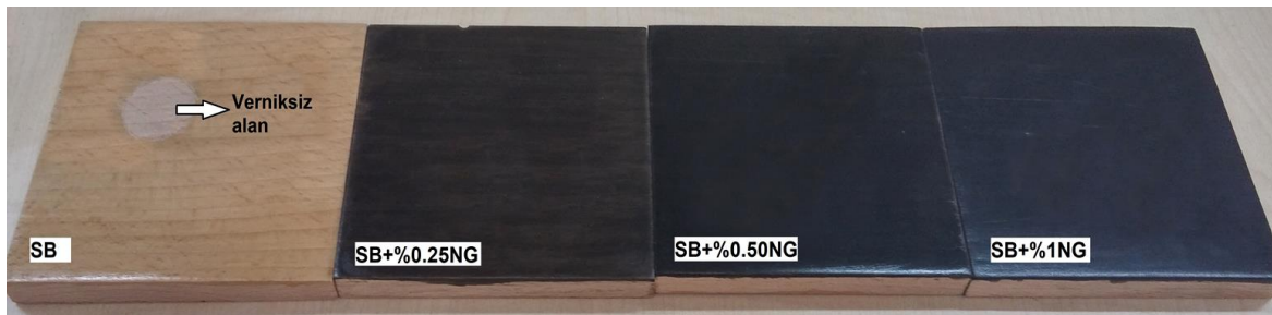
Şekil 3. Verniklenmiş kayın örneklerin görünümü (The appearance of varnished beech samples)
