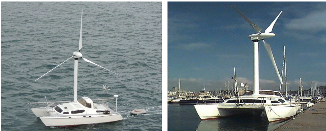
Şekil 5. "Revelation II" gemisi rüzgâr enerjisi uygulaması.
