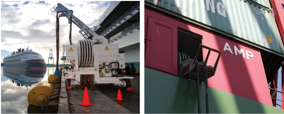
Şekil 11. "Los Angeles Limanı" kıydan enerji temini uygulaması.
