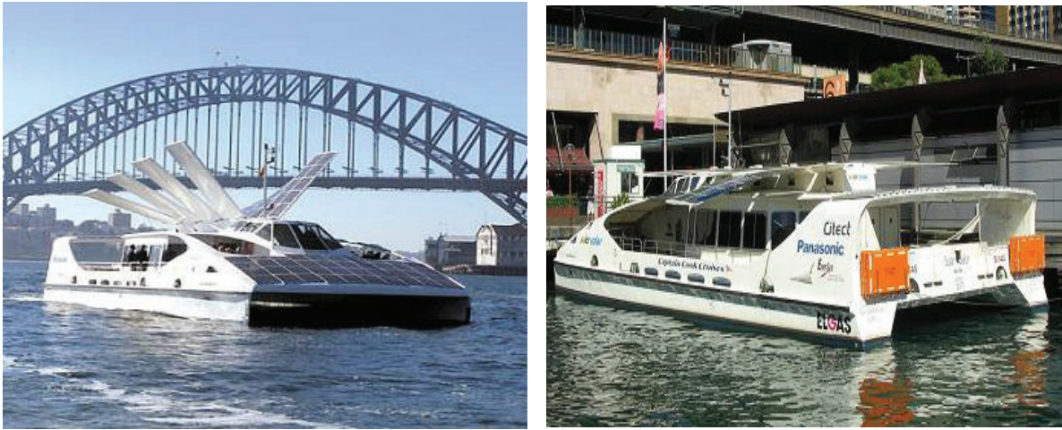
Şekil 1. "SolarSailor" gemisi güneş ve rüzgâr enerjisi uygulaması.
