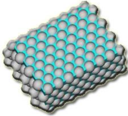
Şekil 2. Elektrokimyasal kaplama ile opallerin arasındaki boşlukların doldurulması (Armstrong ve ark., 2015).
