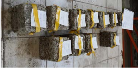
Şekil 7. Pomza numuneleri kullanılarak hazırlanan yapı blokları.
