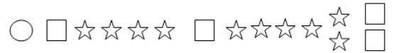
Şekil 3. Adalya bej mermer ocağında kullanılan Fantini 70 SUPER-H zincirli kesme makinesinde keski grubundaki pcd, kare ve yıldız keskilerin dizilimi
