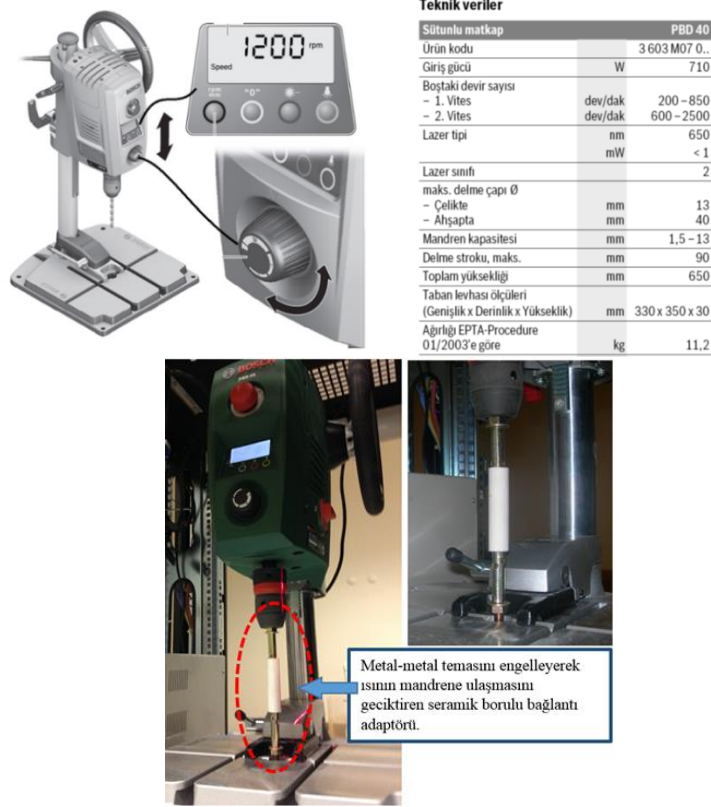
Şekil 11. Karıştırma işlemi için kullanılan matkap tezgahı ve teknik özellikleri
