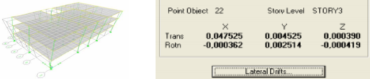
Şekil 13. EXTP Yüklemesi Altında Yapıdaki Şekil Değiştirme ve Noktasal Yer Değiştirme
