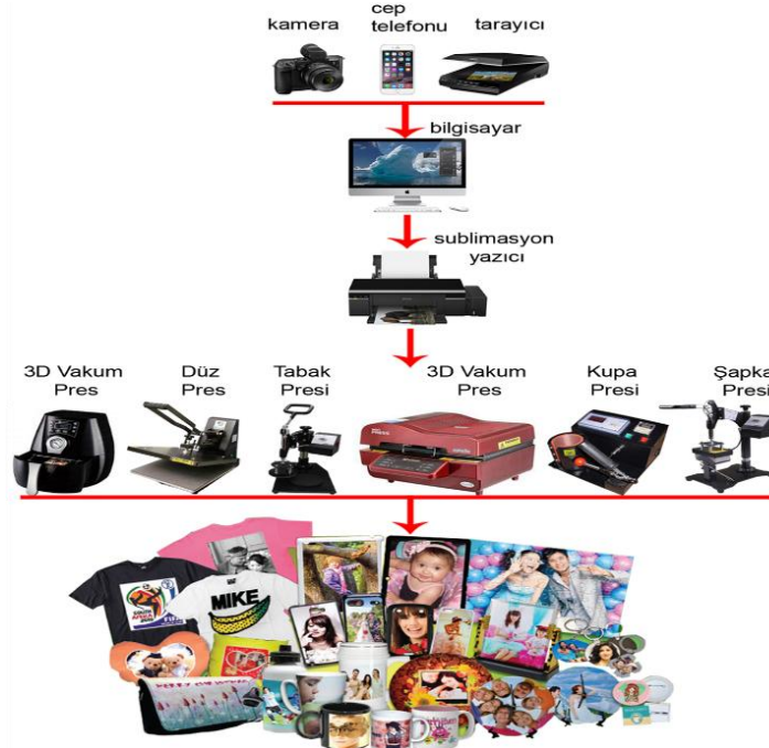
Şekil 9. Transfer baskı prosesi infografik (Sublimasyon nedir? Sublimasyon Baskı Nasıl Yapılır?, 2018).
