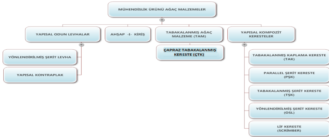
Şekil 1. Mühendislik Ürünü Ağaç Malzeme (MAM) ürünleri (Winistorfer ve Steudel, 2000'den adapte edilmiştir).
