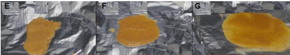
Şekil 3. Akıllı odun biyoplastik kompozitlerin (E): %25 mısır nişastası (F): %50 mısır nişastası (G): %75 mısır nişastası.
