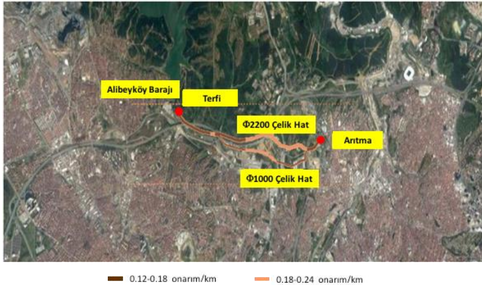
Şekil 6. Örnek uygulama sonucunda bulunan, 50 yılda aşılma olasılığı %10 olan deprem sırasında örnek çalışma alanında oluşması beklenen medyan kilometre başına onarım oranları
