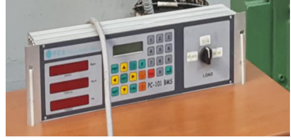
Şekil 1. Dizel test motoru ve dinamometresi kontrol paneli.
