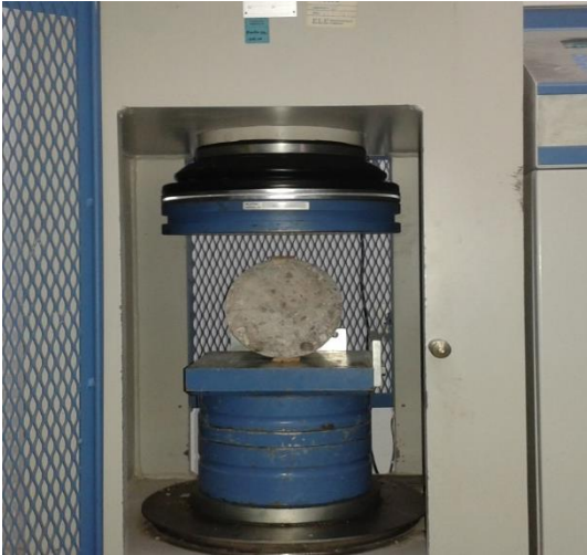
Şekil 10. Disk yarma deneyi için düzenek
