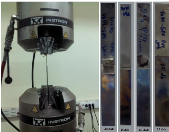
Şekil 6. Çekme cihazı ve kaynaklanmış numuneler
