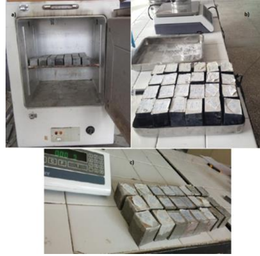
Şekil 2. a) Fırında bulunan örnekler b) Desikatördeki örnekler c) 24 saat sonra suda bekletilmiş örnekler (Benli ve Karatas, 2017)
