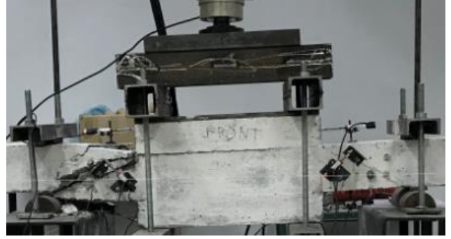
Şekil 15. DS-O numunesinin deney sonlarına doğru hasar gelişimi
