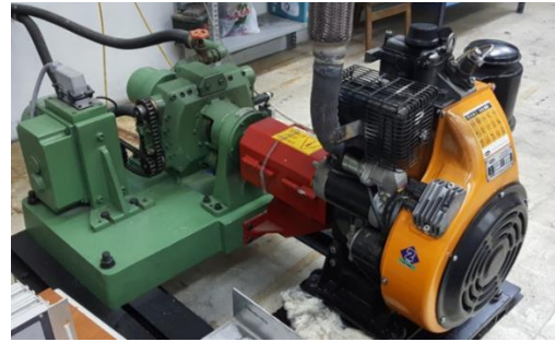
Şekil 2. Dizel test motoru ve dinamometresi.
