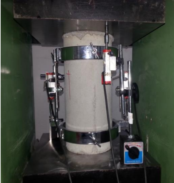
Şekil 7. Silindir basınç deneyine ait düzenek
