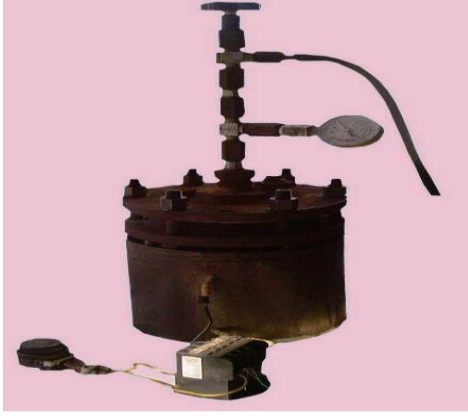
Şekil 1. Sülfürlemenin yapıldığı otoklav
