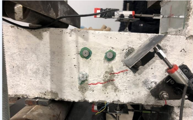
Şekil 13. CCRS-O numunesinde oluşan ilk eğilme çatlağı
